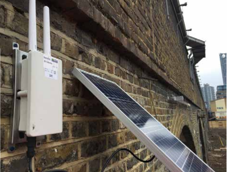
Bild 4: Mobilfunk-Gateway mit Solarpanel zur autarken Stromversorgung
