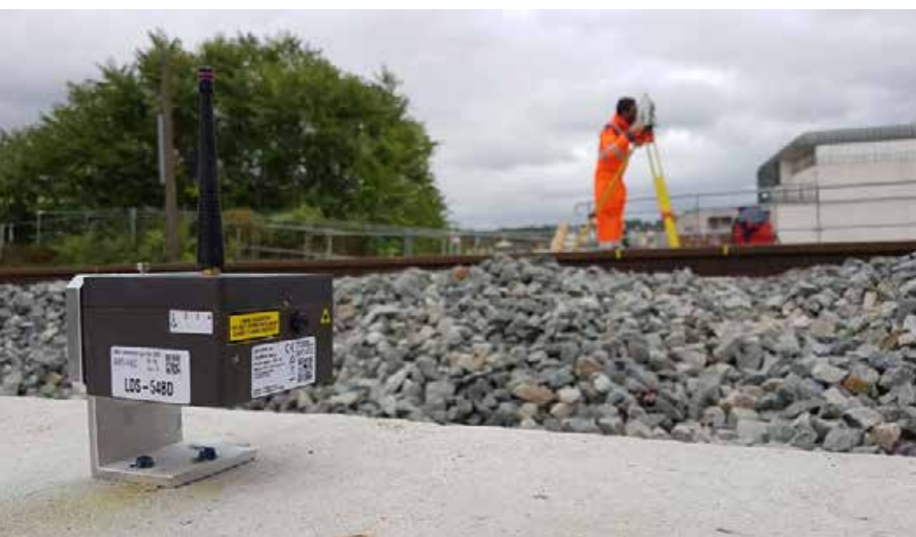
Bild 16: Kombination von Wireless Condition Monitoring mit klassischen, vermessungstechnischen Verfahren ermöglicht zeitlich dichte Beobachtung und effiziente Ressourcennutzung
