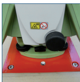
M10-Gewindebohrung mit 84 mm Achsabstand zur Plattenmitte erforderlich.
